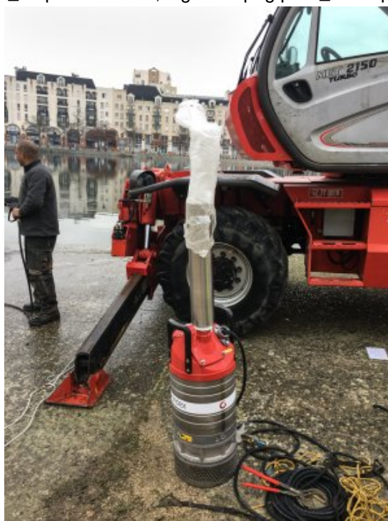
Nouvelle pompe pour le jet central. Crédits : Éric © 2019 - Collectif du lac de Créteil [ http://www.laccreteil.fr/index.php?action=image_responsive&#38;img=IMG/png/pixel_blanc.png&#38;taille=1&#38;1486227457 ]
