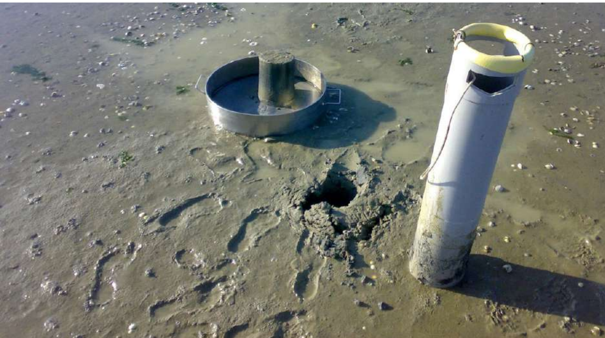
Figure 82 Le matériel nécessaire pour analyser la densité d'invertébrés dans un substrat meuble : un carottier et un tamis (photo GEMEL).
